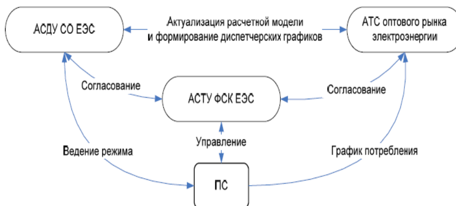
Рис. 1. Участие подстанции в обеспечении процессов функционирования энергосистемы
