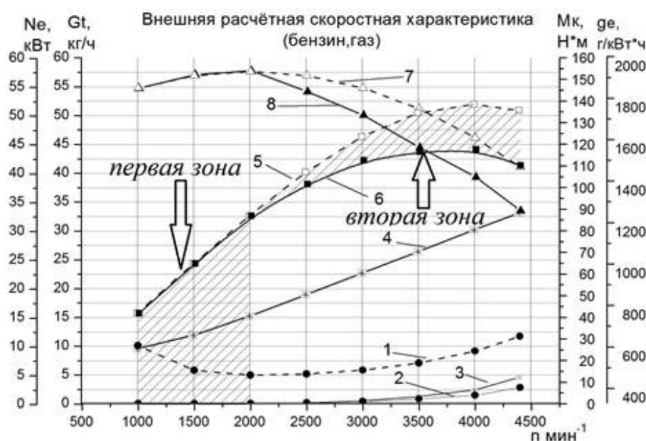
Рис. 1. Теоретическая внешняя скоростная характеристика двигателя, работающего на бензо-газовой смеси: 1 — эффективный удельный расход топлива при работе на газе; 2 — эффективный удельный расход топлива при работе на бензине; 3 — часовой расход бензина; 4 — часовой расход газа; 5 — эффективная мощность при работе на бензине; 6 — эффективная мощность при работе на газе; 7 — крутящий момент при работе на бензине; 8 — крутящий момент при работе на газе
